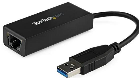
El Adaptador USB 3.0 a Gigabit Ethernet, USB31000S permite agregar un puerto RJ45 Ethernet a una computadora equipada con USB, y ofrece soporte para conectar redes Gigabit con máximo ancho de banda, a diferencia de los adaptadores USB 2.0.
