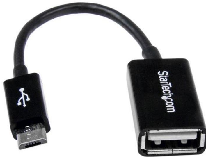
El cable adaptador Micro USB OTG ("On-The-Go", portátil) UUSBOTG incluye un conector Micro USB (tipo B) macho y un conector USB hembra (tipo A) y permite convertir un teléfono celular o un tablet con Micro USB OTG disponible en USB OTG host, así como conectarse a un dispositivo USB periférico como una memoria USB, un mouse o teclado USB, etc.
